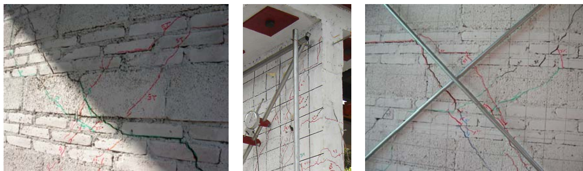
Figura 27. Daño observado para la distorsión de 0.003 propuesta para diseño
