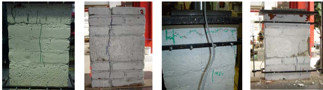
a) Pila con arreglo 1 b) Pila con arreglo 2 c) Pila con arreglo 1 d) Pila con arreglo 2 Fallas por tracción (tensión) lateral Fallas por aplastamiento
