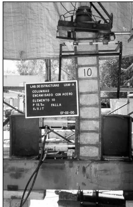
Figura 10. Falla típica de un espécimen de la tercera serie
