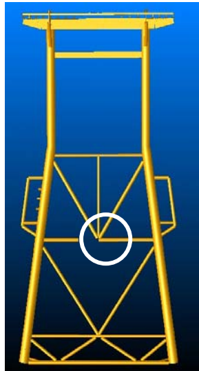
(a) Estado de daño 1: junta N° 1 dañada
