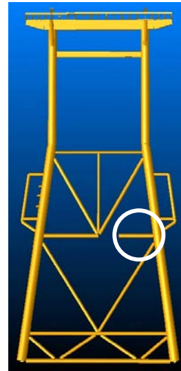
(b) Estado de daño 2: junta N° 2 dañada
