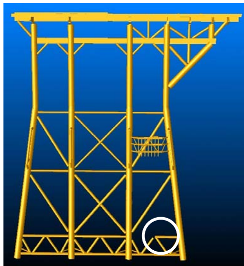
(c) Estado de daño 3: junta N° 3 dañada
