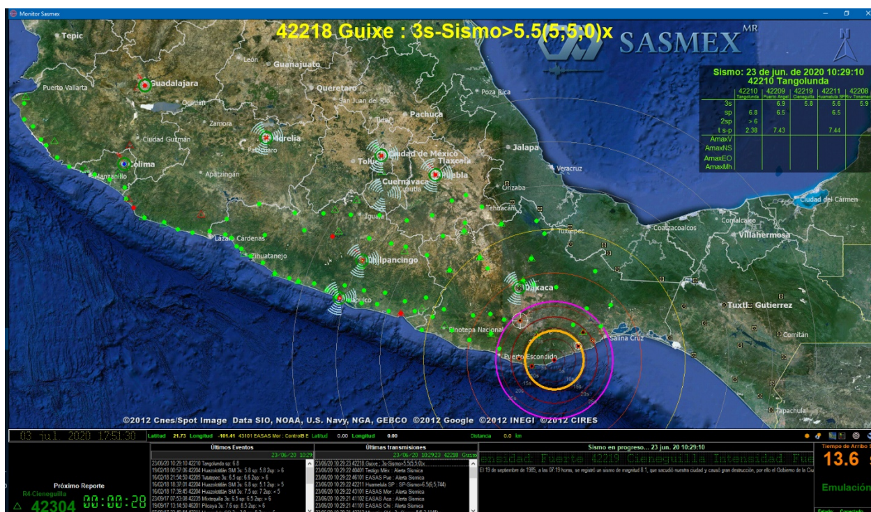
Figura 15.- Monitor SASMEX: aplicación que normalmente se muestra permanentemente en la pantalla.
